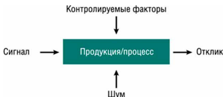
Рис.1. Три типа факторов, выделяемых Г. Тагути, при управлении процессом обеспечения качества создания продукции
