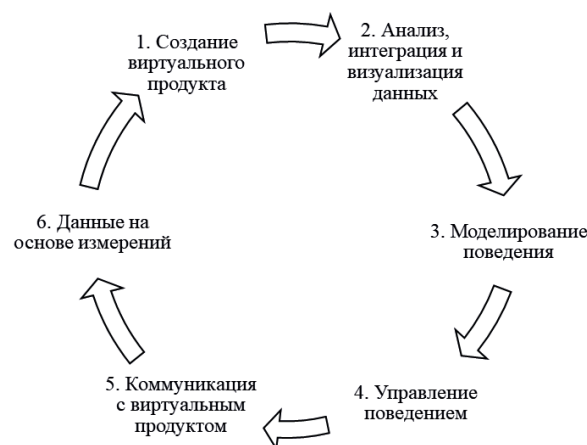
Рис. 1. Схема создания и применения цифрового двойника
